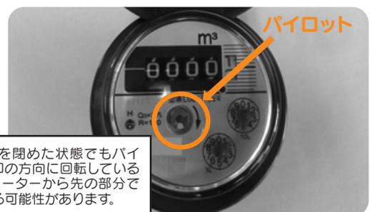
全ての蛇口を閉めた状態でもパイロットが矢印の方向に回転している時は、水道メーターから先の部分で漏水している可能性があります。
